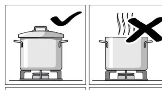
Az edényeket mindig az égő közepére helyezze. Ellenkező esetben az edény felborulhat. Ne tegyen nagy edényeket azokra az égőkre, amelyek közel vannak a kapcsolókhöz. Ez károkat okozhat a túl magas hőmérséklet miatt.
